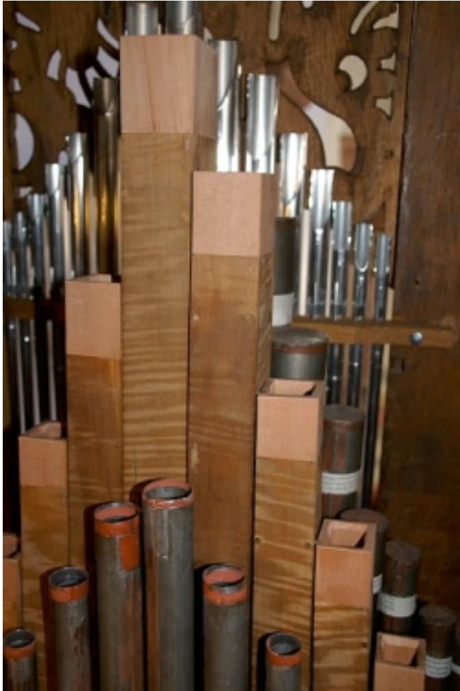
unten im Bild: angelängte Quint (Metall), dahinter angelängte Flaut travers (Birnbbaumholz)
