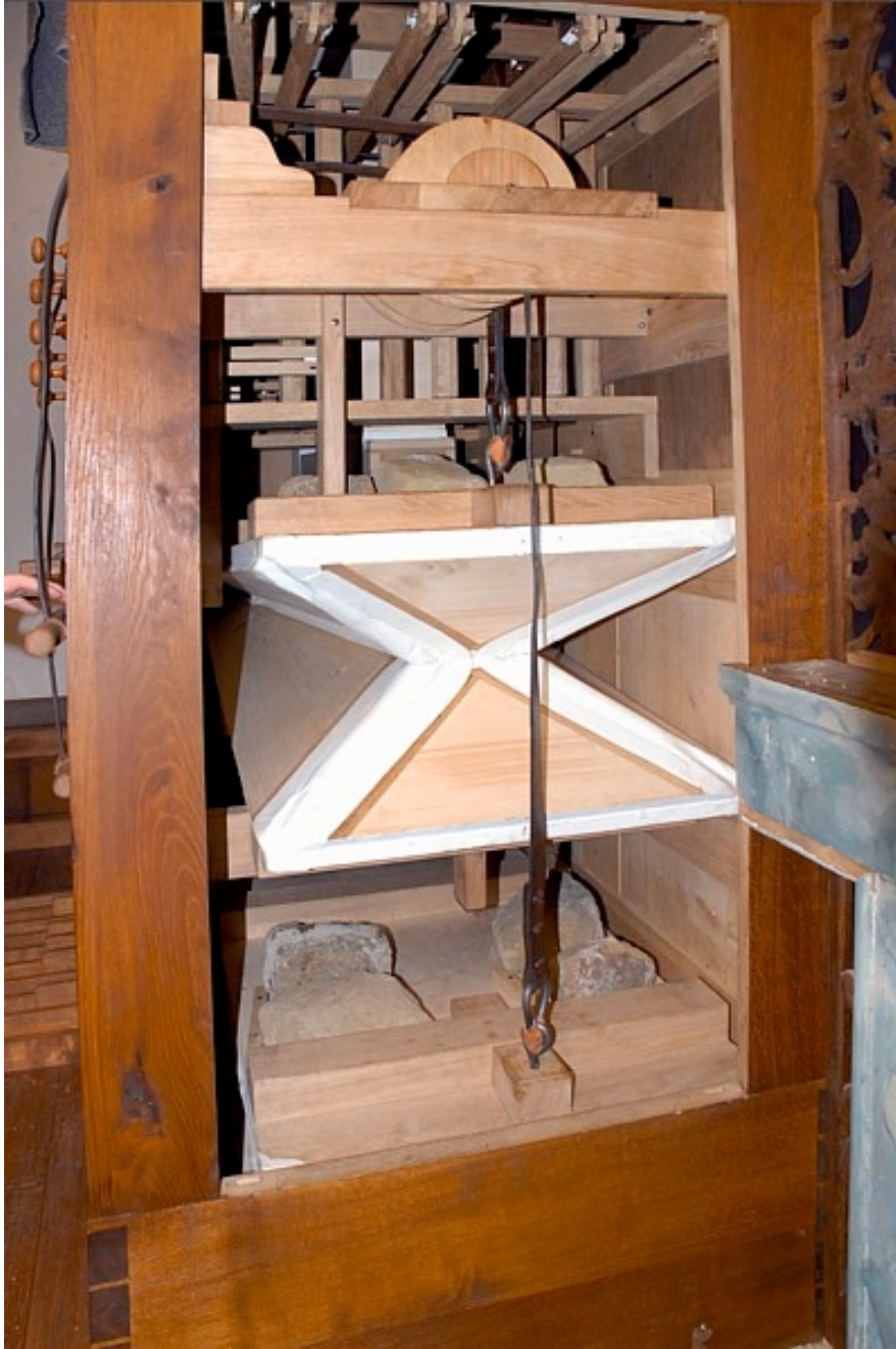
zwei Bälge im Untergehäuse. Ledergurte zur Betätigung durch Kalkanten.
